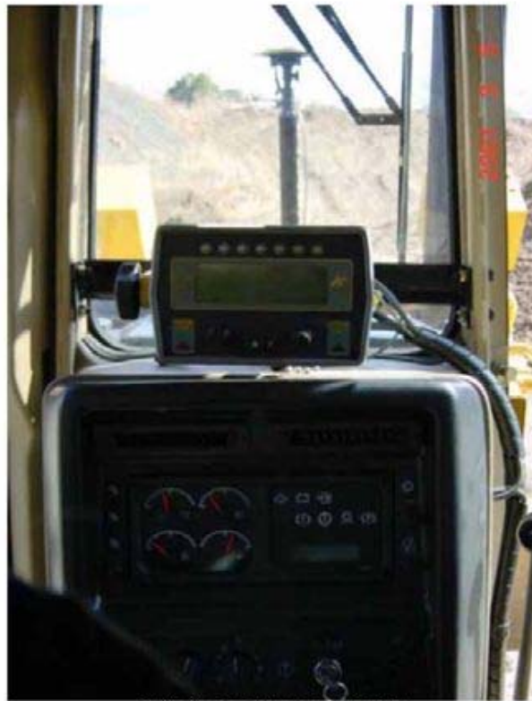
運転席で土工板の指示を確認
